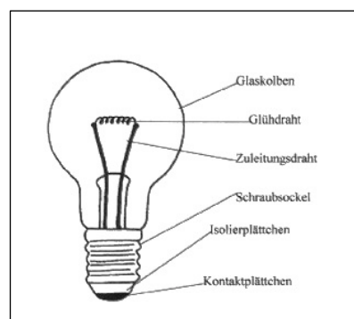
Abb. 1 2 : Die Bestandteile einer Glühbirne.
