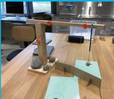
KRAN MIT GEWICHT ZUR STABILISIERUNG
